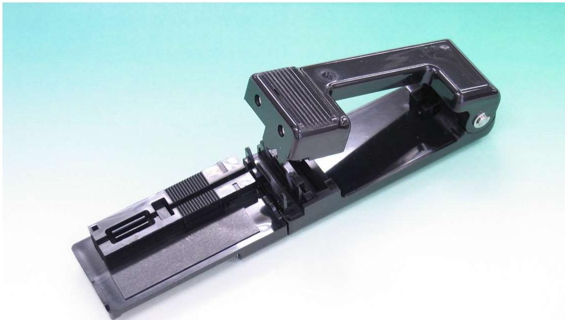
**用途** 現地付けFASコネクタ・FSCコネクタの取り付け前に行う0.5mmファイバ心線の0.25mmへの被覆除去と、0.25mmファイバ心線の被覆除去の2つの機能をひとつにまとめた工具です。
