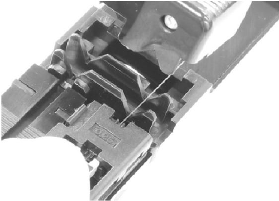
FAホルダにドロップケーブルまたは心線ホルダをセットし、マルチストリッパのスライダに乗せる。
