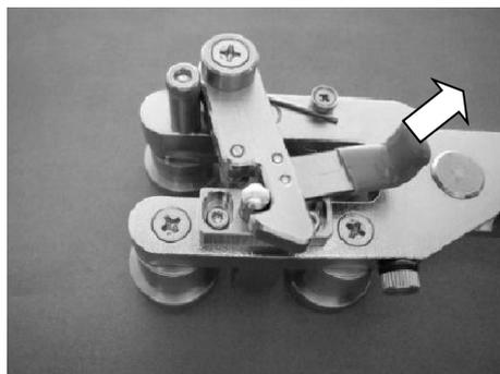
写真の青い柄を矢印の方向に動かす事で、ロックが解除された状態となります。
