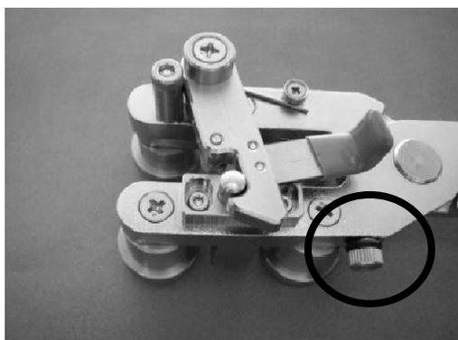
切裂部に工具がセットできない場合には、写真のマルで囲ったネジを廻す事で工具の閉じ幅が+0.5mmまで広げる事が可能です。
